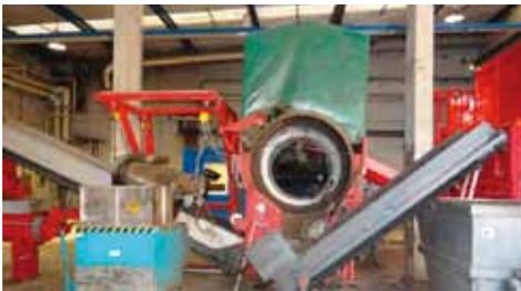
Trommelsiebanlage inklusive Magnetabscheider
